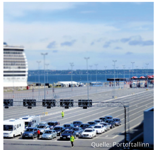
Abbildung 4: Das Hafensystem steuert die Verkehrszeichen und Schilder des digitalen Leitsystems sowie die automatischen Schranken, die zu den Wartezonen führen
